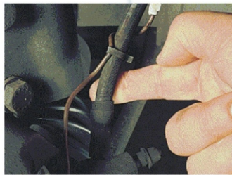
Revise Las Mangueras Estas se Envejecen Deterioran y obstruyen el Sistema
